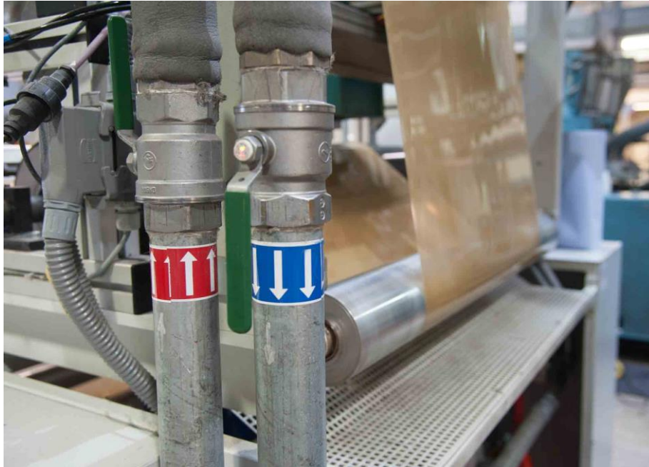
Kaupert Aufmacher: Beim Extrudieren und Tiefziehen von thermoverformbaren Kunststoffen ist eine ausreichende Kühlung entscheidend für die Qualität
