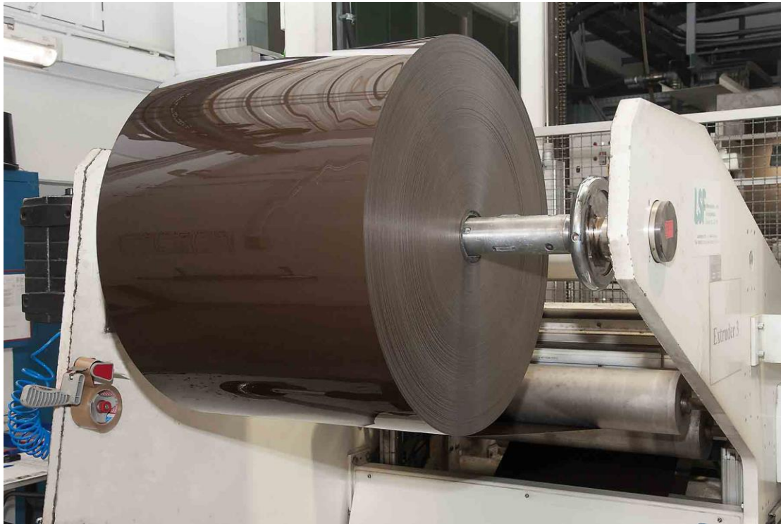
Am Extruder: Eine Rolle Folie kann bis zu 500 kg wiegen und ist mehrere Kilometer lang
